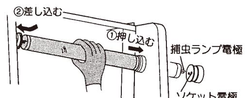
④捕虫ランプを持ち左右に押し込み確実に差し込まれていることを確認する。
