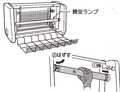
③新しい捕虫ランプ電極部のどちらか一方をソケットに差し込み押し込んでもう一方をソケットに差し込みます。
